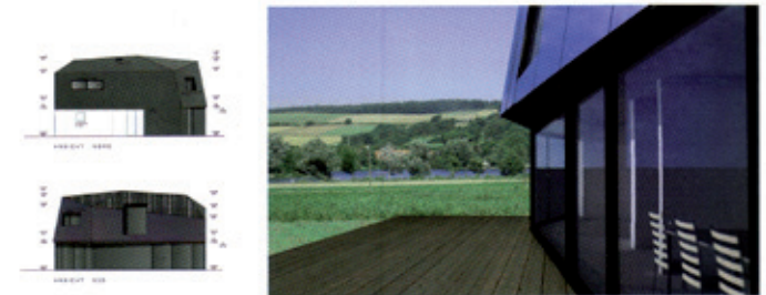
oben: Die polygonale Kristallform ermöglicht eine optimale aktive Nutzung von Sonnenenergie unten links: Solarthermie, Photovoltaikflächen und anthrazitfarbene Fasertafeln treffen kantenscharf aufeinander | unten rechts: Das auskragende Dach bietet einen automatischen sommerlichen Sonnenschutz
